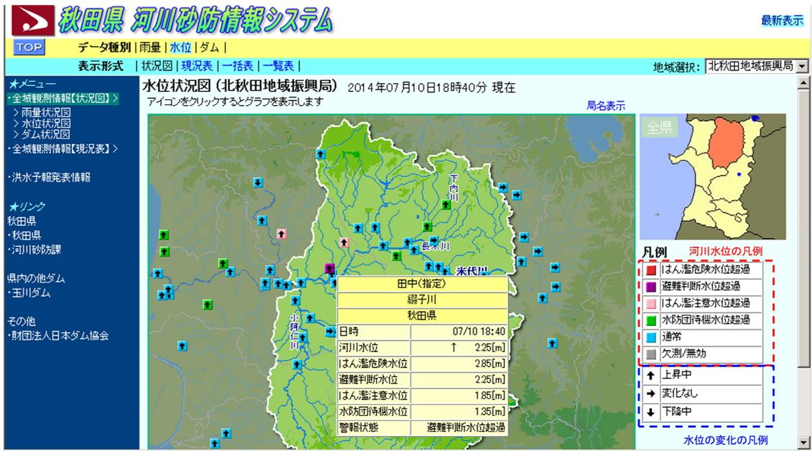
観測所の水位をチェックする。凡例を参照し、観測所の色と水位の変化の矢印を確認する。観測所にマウスカーソルを移動すると、観測所における水位が表示される。更に詳細な水位状況を確認するためには、観測所をクリックする。
