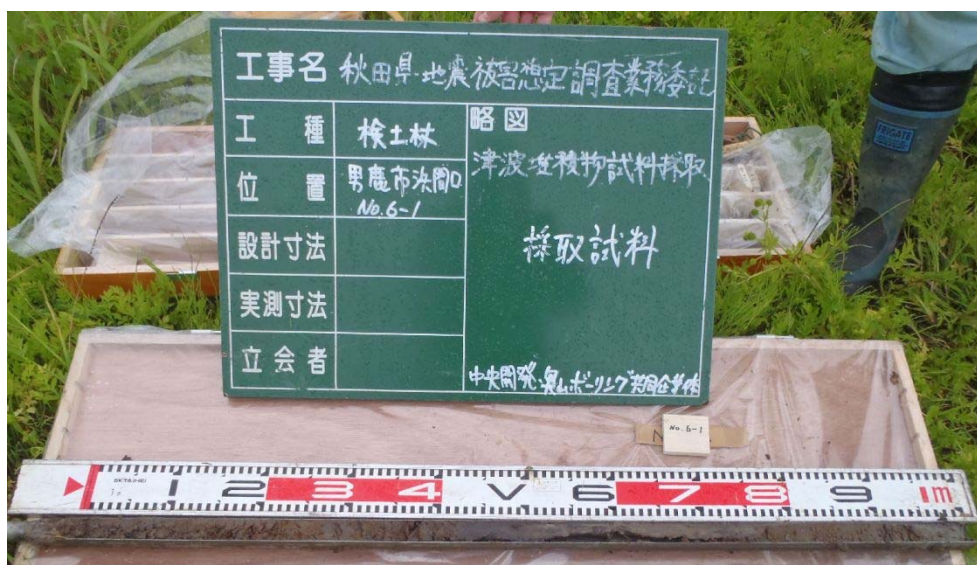
写真-17.4.1.2 検土杖による試料採取
